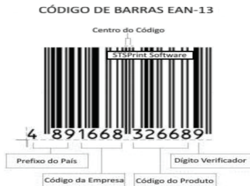
Figura 5 – Explicação do código de barras EAN-13
