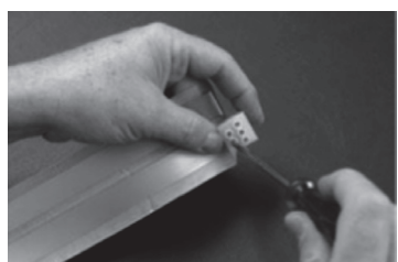
Figura 21 – Centralizar os conectores nas lâminas de metal
