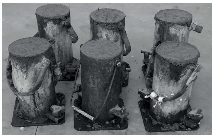
Figura 2 – Moldagem dos corpos de prova de concreto
