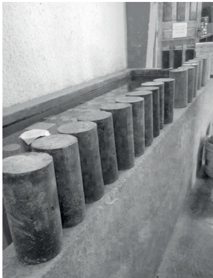
Figura 1 – Corpos de prova (CP's) de concreto
